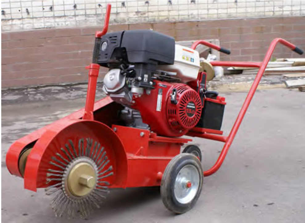
Мал. 4. Машина для розчищення швів та тріщин
